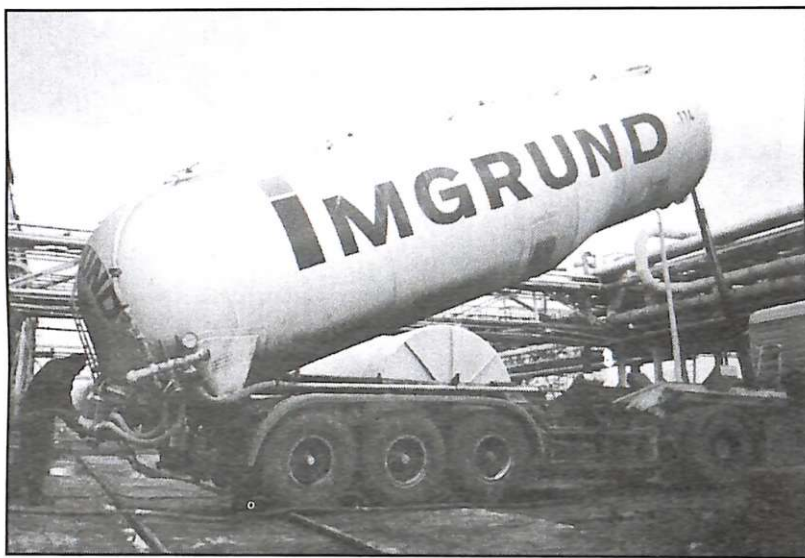
Raz w miesiącu do Zakładu Energetycznego dostarczana jest partia wapna (8–10 ton). Służy ono do uzdatniania wody
